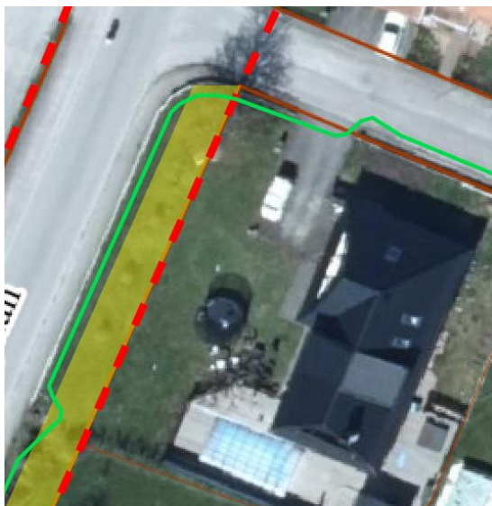
Bild 24 visar delar av Skanovas teleledningar (markerade i grönt) som sträcker sig inom kvartersmark. Planområdet har markerats med rött. Den gulfärgade ytan visar omfattningen av kvartersmark för bostadsändamål.
